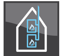
Gasfeuerstätten an mehrfachbelegten Schornsteinen
